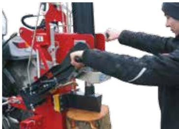
**Einzigartiger Bedienkomfort** - Verwenden Sie die Sicherheitsschaltung als reine Oberbedienung oder als klassische Kombibedienung. Ein beweglicher Bedienarm mit Haltehorn, erleichtert das sichere Positionieren des Spaltgutes, mit dem anderen fix montierten Hebel setzen Sie den Spalter in Gang.
