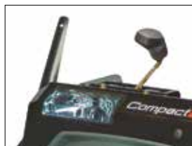
Halogenscheinwerfer: Sicheres Arbeiten auch bei Dunkelheit
