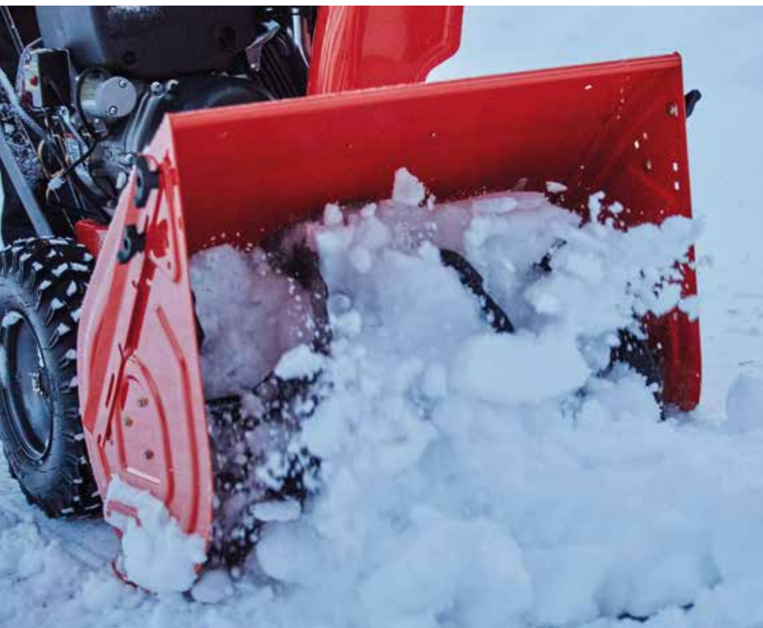
Frostresistentes Hochgeschwindigkeitsschleuderrad mit 35,6 cm Durchmesser
