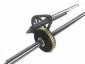
Autoturn – automatische Differentialsperre
